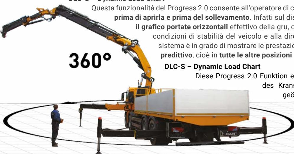
**auf dem Display der Fernbedienung abzulesen**, basierend auf der Stabilisierung des Fahrzeugs und der Winkelposition des Krans automatisch berechnet wird. Darüber hinaus kann das System die Hebeleistung des Krans auch vorsehbar anzeigen, d.h. in allen anderen Winkelpositionen des Krans.
