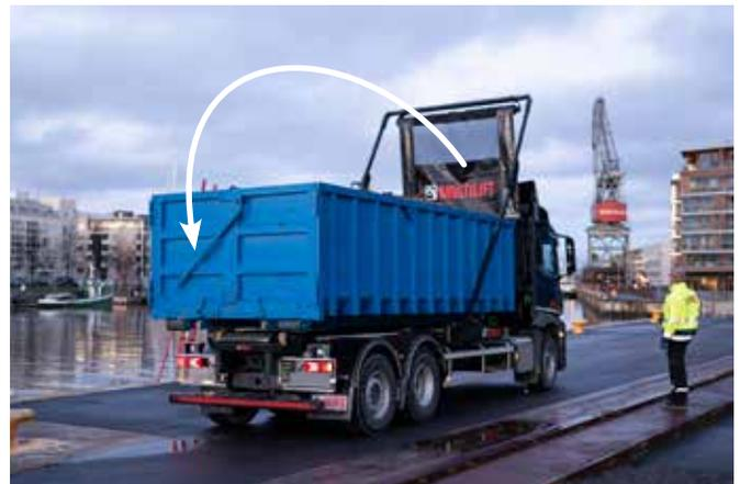
Die Plane kann ganz nach Bedarf hinten am Ladecontainer oder hinter der Fahrerkabine verankert werden.
